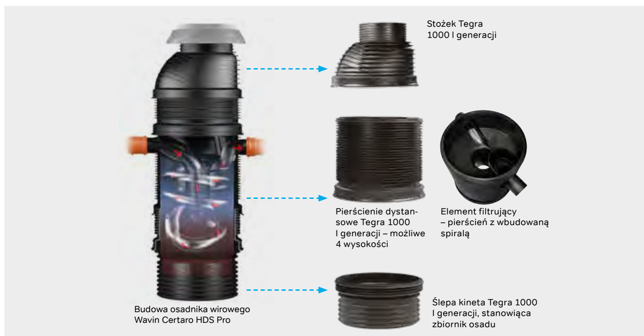
Rys. 41. Elementy osadnika wirowego Certaro HDS Pro.
