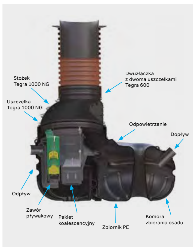
Rys. 43. Budowa separatora Wavin Certaro NS.
