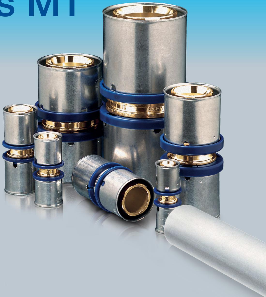
Wavin Tigris M1 est la solution complète de raccords à sertir en laiton pour les tubes multicouches de diamètre 50 à 63mm. Le système peut être utilisé aussi bien pour la distribution de systèmes d'eau chaude et froide sanitaire que pour le chauffage à basse et haute température.
