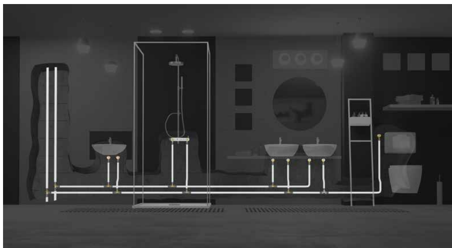
Fig. 42: T-stykke installation.
