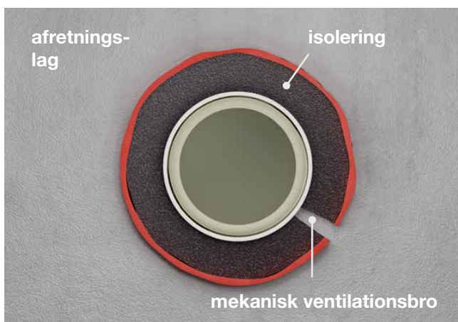
Fig. 41: Mekanisk vibrationstransmission gennem defekt rørisolering
