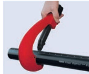
Ablängen von Rohren mit einem Rohrschneider.
