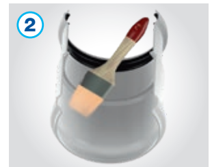
Abb. 32: Herstellen der Verbindung mit Aufsteckmuffe.
