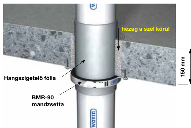
20. ábra: Egyenes beépítés karmantyú / tok nélkül 160 mm-ig.
