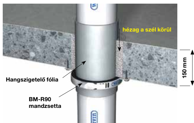
21. ábra: Egyenes beépítés karmantyúval / tokkal / anélkül.
