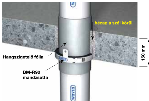
17. ábra: Egyenes beépítés karmantyúval / tokkal / anélkül.
