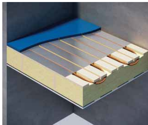
Fig. 4 Wavin gulvvarmerør lagt i varmfordelingsplater i spaltegulv i et mellombjelkelag Figur: Wavin
