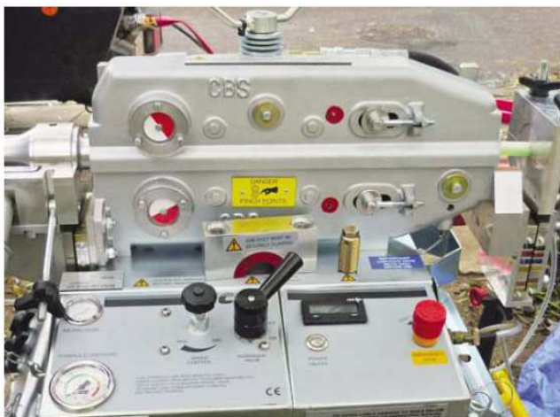
Фот. 4 Приспособление для вдувания микротруб Торгового предприятия „Elmat” sp. z o.o.” с г. Жешов, подготовленное для вдувания трех микротруб Novomicro 10 в волоконно-оптический трубопровод в г. Бжеск.
