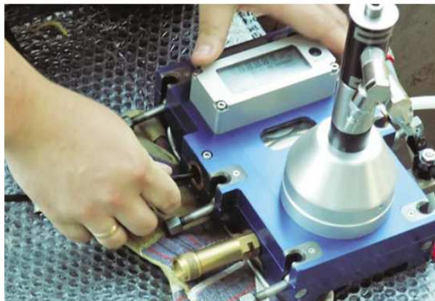
Фот. 10 Вдувание микрокабеля MKLX6 (жесткий микрокабель с диаметром 5, 8 мм, количество волокон от 12 к 72) в Novomicro 10/8 – фотография открыта для доступа Торговым предприятием „Elmat” Sp. z o.o.”.
