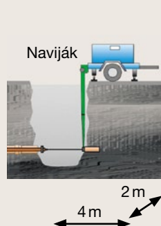
Koncový výkop během zatahování potrubí
