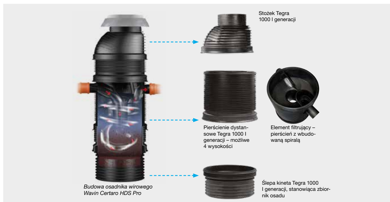
Rys. 39. Elementy osadnika wirowego Certaro HDS Pro
