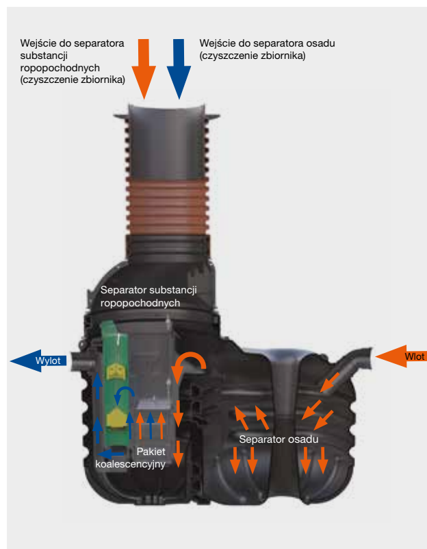
Rys. 42. Zasada działania separatora Wavin NS
