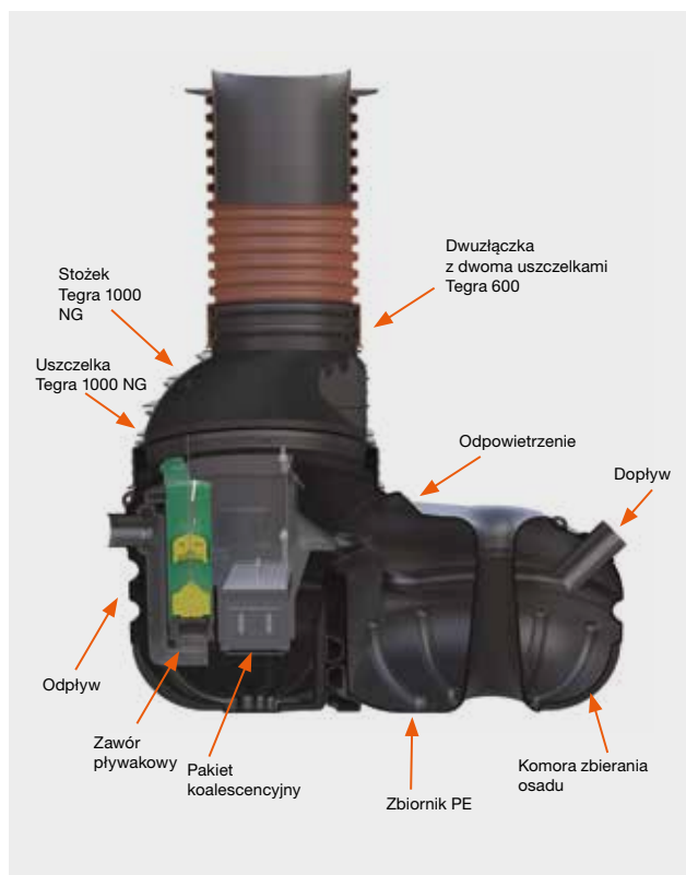
Rys. 41. Budowa separatora Wavin Certaro NS
