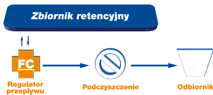
Rys. 18. Ograniczenie przepływu za systemem retencyjnym, włączonym do sieci kanalizacji deszczowej
