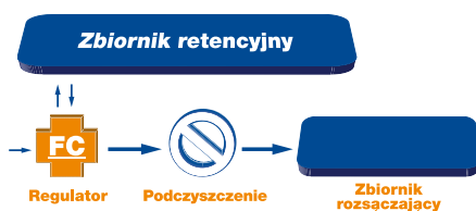
Rys. 19. Ograniczenie przepływu przed systemem podczyszczania i wypływu do zbiornika rozszczajającego
