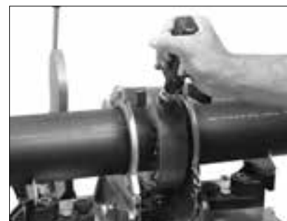
Srovnání konců potrubí hoblíkem
