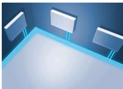
Двухтрубная кольцевая система
