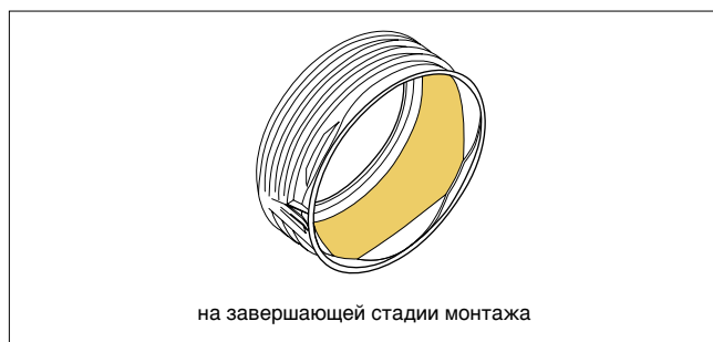
Рис. 4. Место контакта резинового уплотнителя и внутренней поверхности раструба
