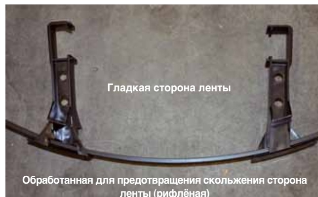
Рис. 4. Деталь – расположение кронштейнов лестницы на ленте. Обработанная для предотвращения скольжения сторона ленты – со стороны гофрированной трубы, гладкая сторона ленты – внутрь колодца.
