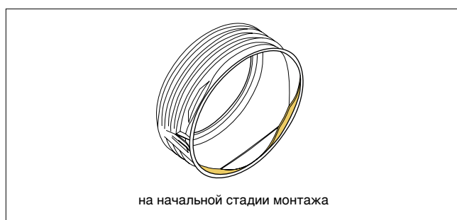
Рис. 3. Положение уплотнительной прокладки
