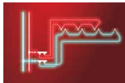
Järjestikune ringühendustega süsteem (kasutatakse läbijooksuga kraanipilvi)
