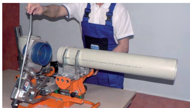
Przestawienie po nagrzaniu.
