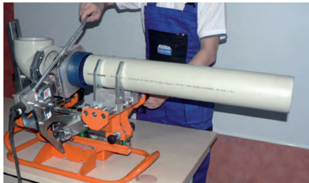
Montaż w narzędziu i wycentrowanie, potem nagrzanie.
