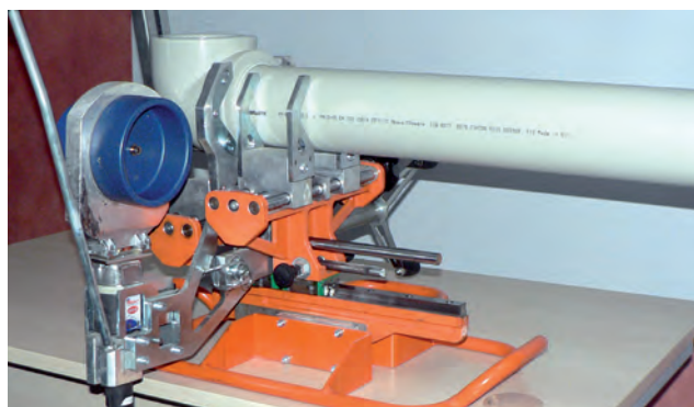
Gotowy zgrzew po wystygnięciu.
