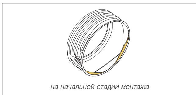
Рис. 2.5 Положение уплотнительной прокладки
