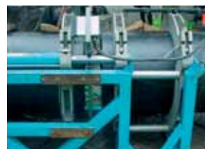
Рис. 19. Сварка встык полиэтиленовых труб
