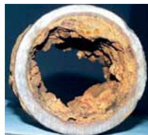
Рис. 2. Отложения в водопроводе питьевой воды
