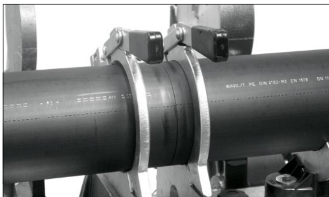
Správně připravené potrubí ke svařování
