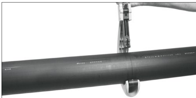
Řez potrubí ruční rotační řezačkou
