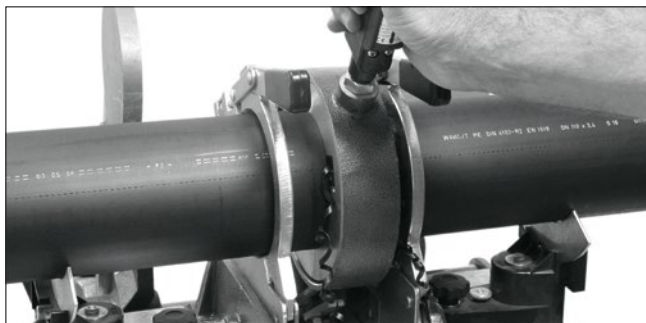
Srovnání konců potrubí integrovaným hoblíkem
