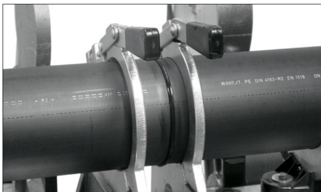
Chladnutí svařeného spoje
