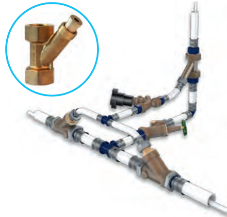
Abb. 15: Fittings zum Einfädeln der innenliegenden Zirkulation in die Steigleitung und vormontierte Anschluss-Sets für den Verzug in der Etage.
