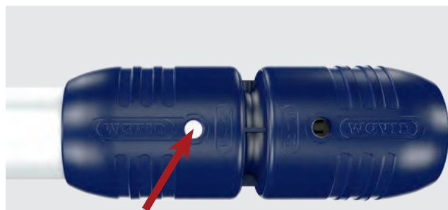
Abb. 9: Über ein Sichtfenster in der Kappe lässt sich prüfen, ob das Rohr bis zum Anschlag gesteckt ist.
